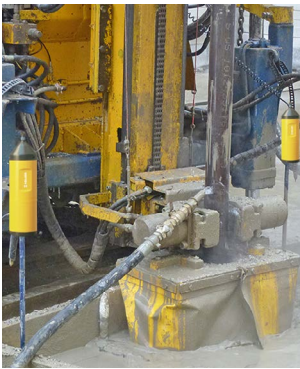
Versuchsaufbau zur Durchmesserbestimmung mittels ACI® ACI® test setup to determine the diameter of columns
